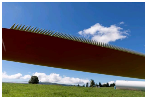
Photographies d'une pale dotée d'un système STE (peigne / dentelure)
